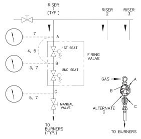
Fig. 41: Leak Test
