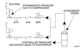
FIG. 4 -MULTIPLE COMPRESSOR ECONOMIZER SYSTEM
